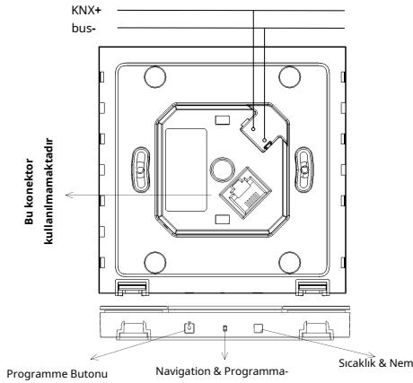
Cihaz, sol üst ve sol alt köşedeki butonlarına aynı anda basılı tutulduktan sonra sağ alt köşedeki butona basılarak programlama LED' aktif hale getirilir ve LED'in kırmızı ışığı yanar. Ayrıca, direkt programlama butonuna basılarak da aynı işlem yapılmış olur. Daha sonra cihaz programlanmaya hazır hale gelmiş olur.
