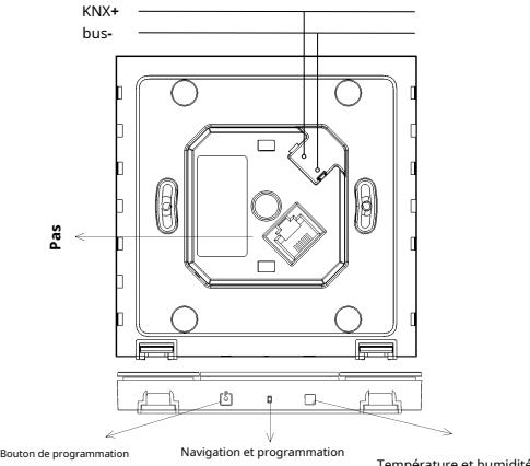
Après avoir appuyé simultanément sur les boutons en haut à gauche et en bas à gauche de l'appareil, la LED de programmation est activée en appuyant sur le bouton dans le coin en bas à droite et le voyant rouge de la LED s'allume. En outre, cela peut être fait en appuyant sur le bouton de programmation comme autre méthode.
